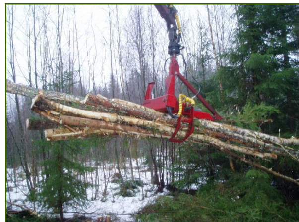
Кассета с ножом повернута: захват можно грузить полностью
